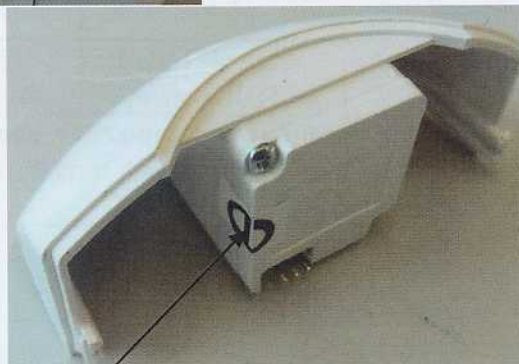
Рисунок 2 - Схема пломбировки корпуса ФСТ-05КБ от несанкционированного доступа и место нанесения знака поверки
