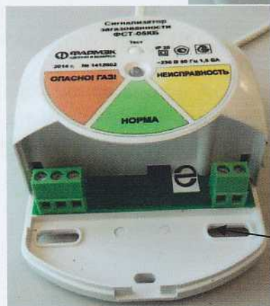
Рисунок 2 - Схема пломбировки корпуса ФСТ-05КБ от несанкционированного доступа и место нанесения знака поверки
